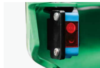
Ein Fußsensor bremst das Fahrzeug (gegebenenfalls bis zum Stillstand), sobald er feststellt, dass sich ein Fuß des Fahrers außerhalb der Plattform befindet (Fahrermodell).
