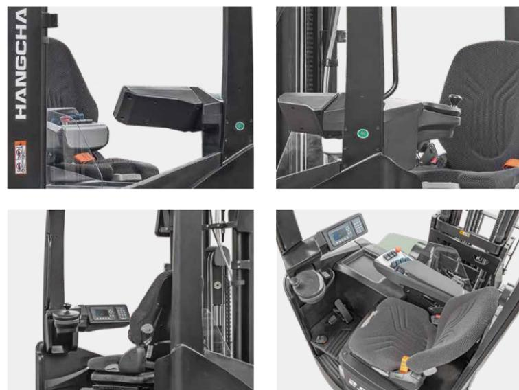
Besonderer Wert wurde auf ein möglichst unbehindertes Sichtfeld gelegt. Batterieform und Aufbau des Fahrertraums wurden daraufhin optimiert.
