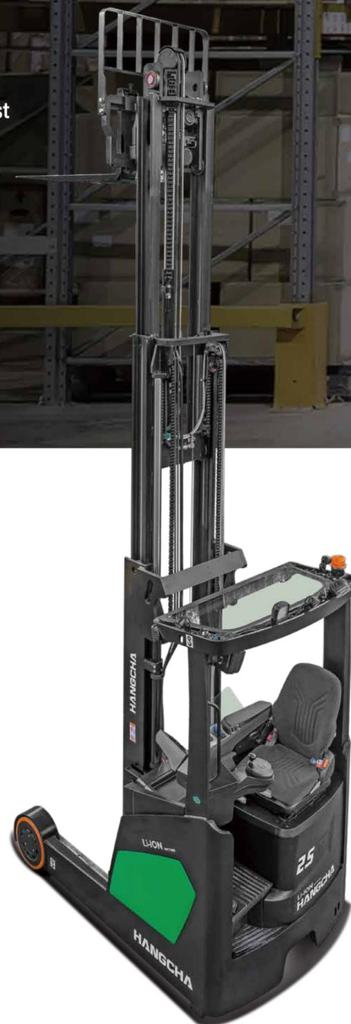
**Optimale Sicht auch beim Stapeln – hier hilft die angepasste Struktur des Hubgerüsts und die Anordnung der Rohre.**
