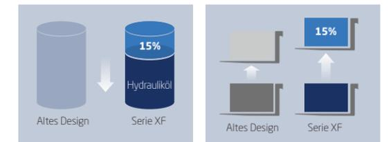
Das patentierte dynamische Lenksystem mit Lastsensor beugt Hydraulikverlusten vor, verbessert die Energiebilanz und erhöht die Hubgeschwindigkeit um 15%.
