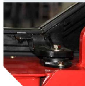
Vier Dämpfpegel liegen vor, um den Fahrer vor rüttelndem Untergrund zu schützen. Dämpfplatten sind vorhanden zwischen Lenkachse und Chassis, zwischen Motor, Drehmomentwandler und Chassis sowie zwischen Fahrerschutzdach und Chassis. Der vollgefederte Sitz wirkt in gleichem Sinn.
