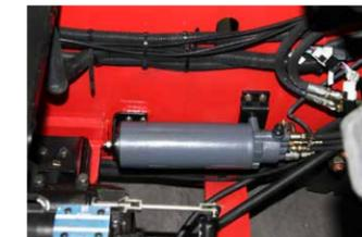
Im Bremssystem wurde ein Energieakkumulator verbaut, der beim Abschalten des Motors ein Höchstmaß an Bremsenergie für Notbremsvorgänge liefert.
