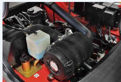
Gänzlich neu entworfen wurde die gestanzte Luftfiltereinheit mit schrägem Einlass, doppelter Dichtung und Sicherheitsfilter, korrosions- und schwingungssicher mit langer Lebensdauer. Mit geringstmöglichem Ansaugwiderstand wird beste Filtereffektivität geboten.
