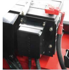
Alle Regler, Schaltkreise und Sicherungen liegen im wasser- und staubdichten Schaltkasten. Da die elektronischen Komponenten ebenfalls wasserdicht geschützt sind, sind Arbeiten in problematischer Umgebung jederzeit möglich.
