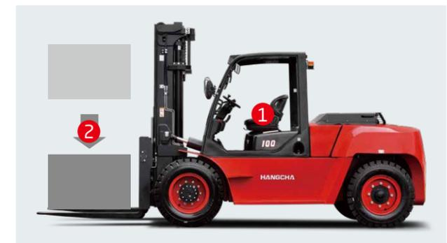
1. Das Sensorsystem im Sitz enthält Funktionen zum Sperren von Heben/Kippen sowie Fahrverriegelung. Niemand kann Hebe- und Kippvorgänge auslösen oder das Fahrzeug in Betrieb nehmen, sobald der Fahrer den Sitz verlässt.
