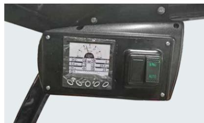
Interaktive Instrumententafel mit vier Bedientasten und LCD - Bildschirm sowie CAN Bus Kommunikationsstandard. Das Verbindungsprotokoll ist kompatibel mit CANOpen und SAE 1930.
