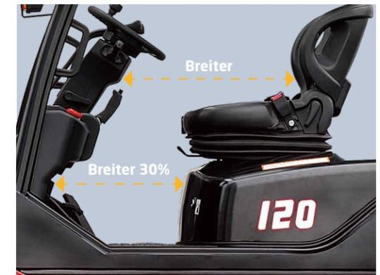
Auch der breite Fußraum trägt zum Wohlbefinden des Fahrers bei, so dass er weniger ermüdet. Ein- und Ausstieg erfolgen über eine rutschfeste Stufe.
