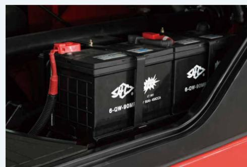
Die Batterie liegt oberhalb des Dieseltanks, abgeschirmt durch Batteriegehäuse und adiabatische Platte.
