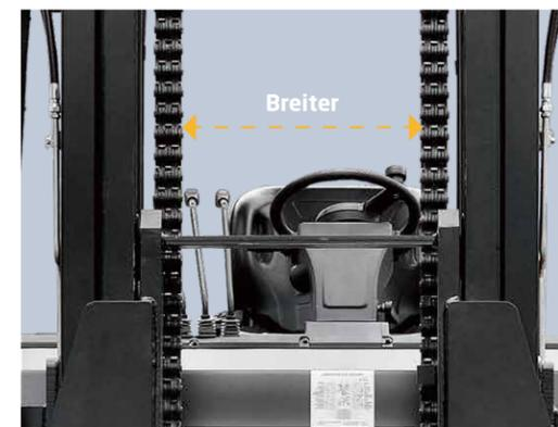
Die Hydraulikrohre beim neu konzipierten Hubgerüst liegen außerhalb des Zinkenverstellgeräts, so dass in der Mitte ein breites Sichtfeld verbleibt.
