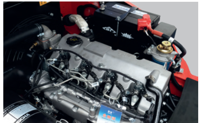
HC-Dieselmotor mit Hochdruck Bosch Common-Rail-Einspritzung
